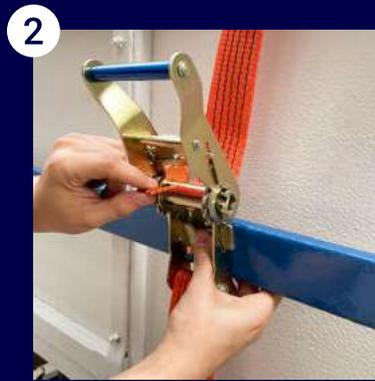
2 Passe a fita pelo vão do eixo da catraca. (máximo cinco voltas).
