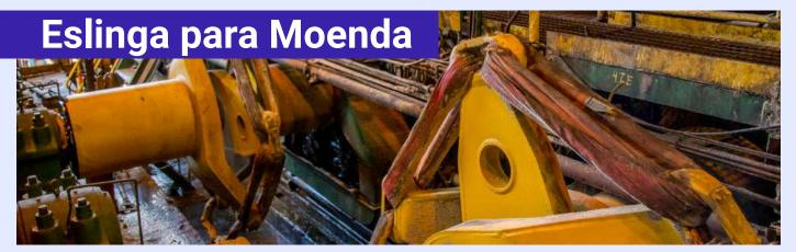
Usadas perfeitamente para substituir correntes e cabos de aço, as eslingas para moenda possuem mais performance, durabilidade e resistência no processo de funcionamento do acoplamento. Em razão de sua flexibilidade, a eslinga absorve o impacto e permite melhor desempenho dos eixos, além de resistirem com eficácia a tração constante dessas máquinas para maior vida útil. As eslingas são fabricadas com capa dupla, evitando seu desgaste precoce durante a sua operação.
